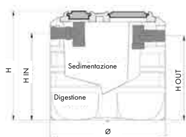
Dimensionamento per spurgo fanghi semestrale
