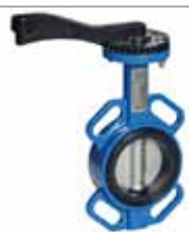
VALVOLA WAFER CON LEVA, CORPO IN GS, LENTE INOX 316 ART. 1003 EPDM
