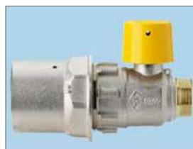
Valvola a sfera per colonna montante gas, con cappuccio piombabile, a passaggio totale, filettatura maschio sfero-conico ed attacco PE, raccordo per tubo di protezione in acciaio.
