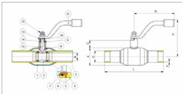
Valvola a sfera in acciaio, passaggio ridotto, completamente saldata, **per gas colonna montante M.P.**, con estremità a saldare di testa, con leva.
