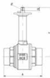
**Valvola a sfera a interrare in acciaio ASTM A105/WCB**, passaggio totale, saldare di testa, secondo UNI 9734, per gas naturale, con prolunga e quadro di manovra.
