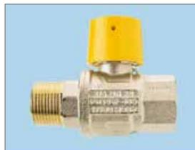
Valvola a sfera per colonna montante gas, a passaggio totale, filettatura M/F, con cappuccio piombabile.
