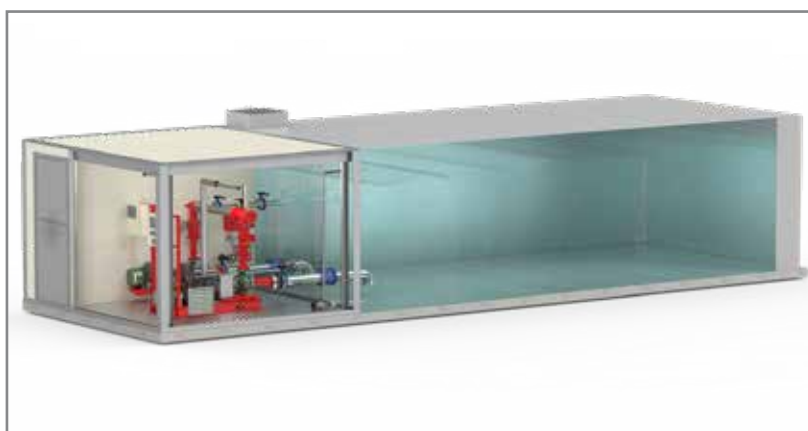
Impianto antincendio da esterno composto da serbatoio di forma parallelepipedica e locale tecnico solidale, con pompe centrifughe orizzontali
