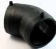
GOMITO 45° ELETTROSALDABILE PN16 - SDR11
